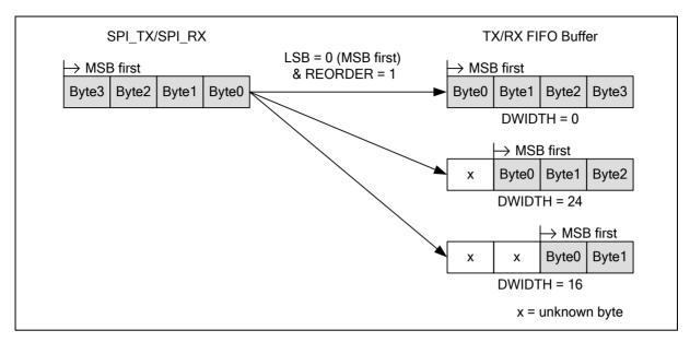
Figure 6.17-8 Byte Reorder Function
