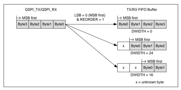
Figure 6.18-8 Byte Reorder Function
