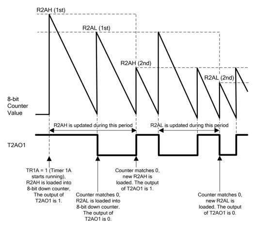
Figure 10.3. Timer 2A PWM Waveform
