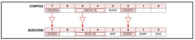
Figure 29.2. CONFIG2 Power-On Reset Reloading
