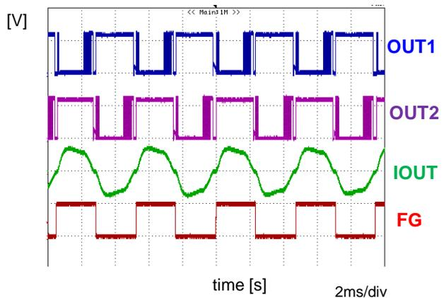
condition :  $V_{CC} = 24V, PWMI=100\%duty$
